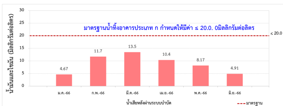
รูปที่ 3-4 (ต่อ) กราฟแสดงผลการตรวจวิเคราะห์คุณภาพน้ำทิ้งหลังผ่านระบบบำบัด ระหว่างเดือนมกราคม-มิถุนายน พ.ศ. 2566
